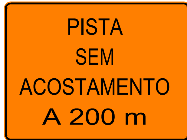
DETALHE DE PLACA DE COMPLEMENTAR 2,00x1,50m
