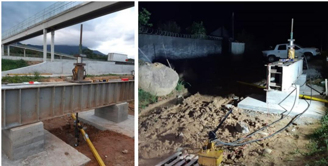
Figura 26: Ensaio de Prova de Carga – Microestaca Passarela
